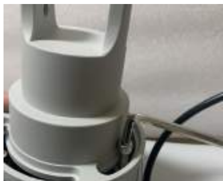
⑦ソーラーパネルの向きを決め、ボルトをきつく締めて下さい。
