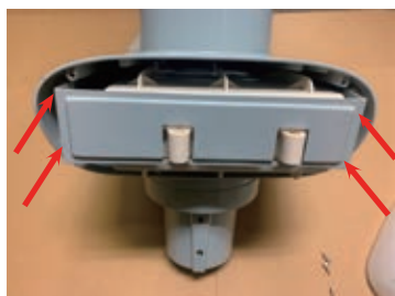
②六角レンチで4カ所のボルトを取り外します。
