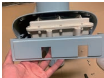
③バッテリーの固定用金具を取り外します。
