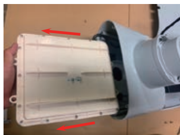
⑦古いバッテリーを取り出します。
