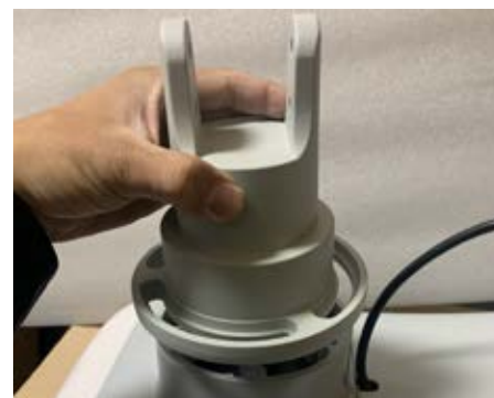
⑥ソーラーパネルを取り付ける為の金具を合わせて下さい。
