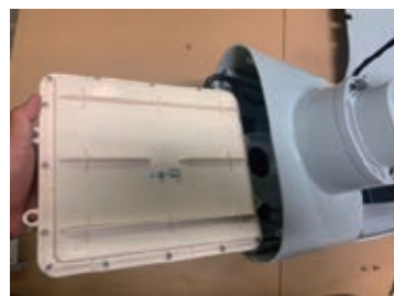
⑧新しいバッテリーを挿入します。これでバッテリー交換完了です。
