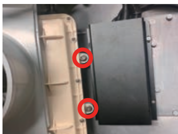
⑤六角レンチで2カ所のボルトを取り外します。
